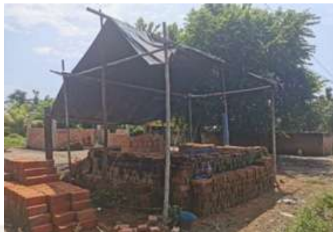
Imagen 130. Cubierta con plástico de horno
