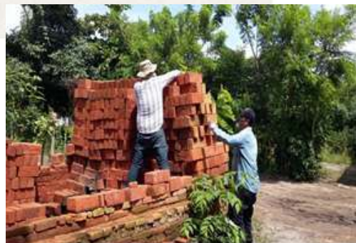
Imagen 135. Toma de muestra de tabiques
