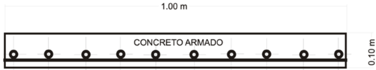
Figura 28. Corte del TRC y el acero de Refuerzo que contiene.
