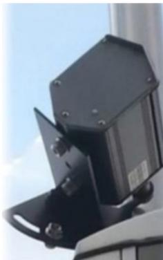
Fuente: Radar de intersecciones RAD-TMA122 doppler para semáforo. Quadrex. <https://www.quadrex.es/>
