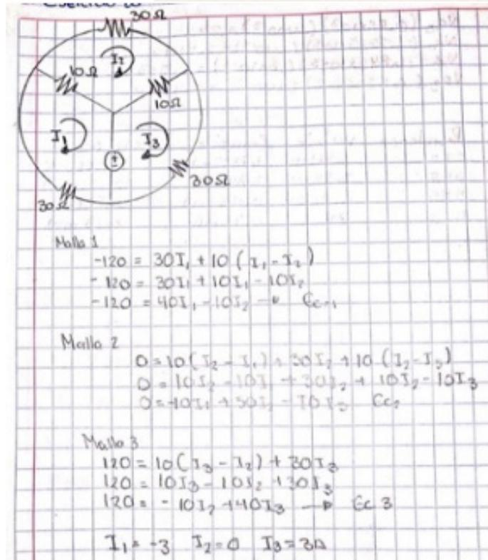
Al resolver sus ecuaciones algebraicas puede determinar el valor de la corriente  $I_2=0$ , en tanto su voltaje es de 0 volts. Con lo que puede comprobar con el simulador, ver figura 10.
