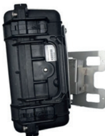
Figura 5.5. Radar registrador de datos tipo Doppler TMS-SA
