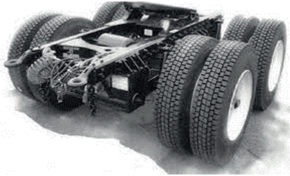
Figura 2.12. Convertidor de dos ejes, tipo H
