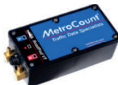
Figura 5.2. Aforador de tráfico portátil ROADPOD VT-5900
