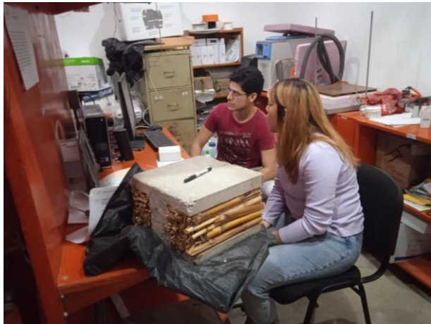
Figura 4. Sección de la losa térmica.
