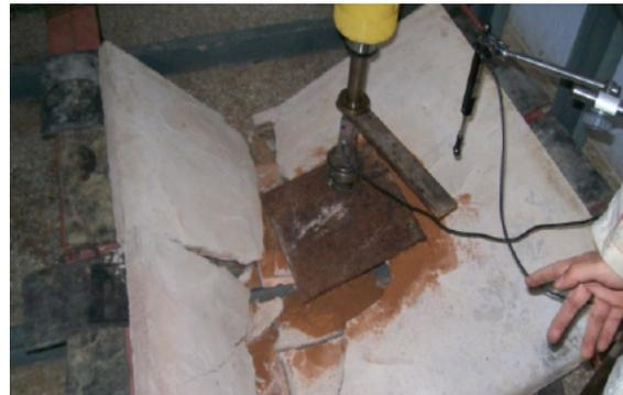
Figura 32. Falla probeta A1
