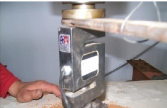
**Figura 24.** Celda de carga
