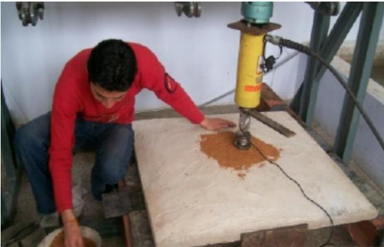
**Figura 23.** Colocación de arena
