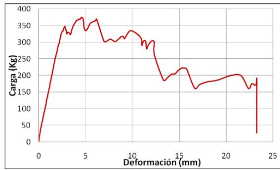
**Figura 39.** Probeta con alambres perimetral y transversal
