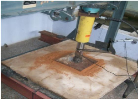
**Figura 30.** Agrietamiento de probeta
