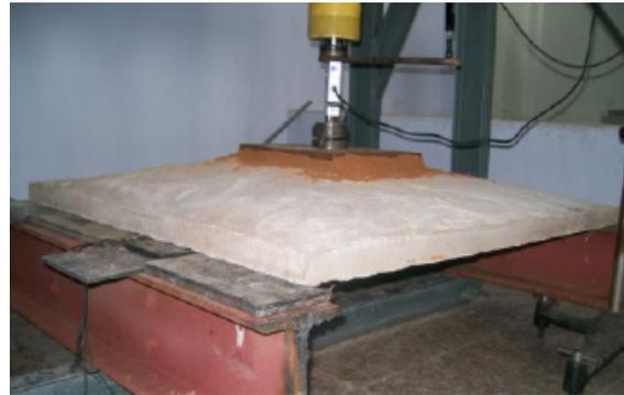
**Figura 27.** Vigas de apoyo
