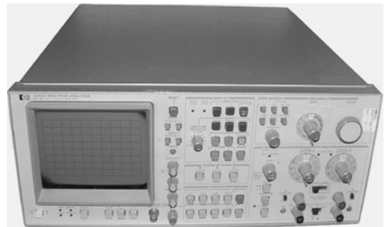
Figura 2. Analizador de espectros HP 3582A.
